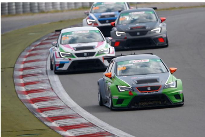
upraveno sání vzduchu a kapota motoru dostala centrálně umístěný nasávací otvor. Ze sériového modelu byly převzaty přední a zadní LED světlomety, zachována zůstala charakteristická linie karoserie, avšak došlo k jejímu rozšíření o 166 mm. Tím šířka vozu narostla na 1950 mm při délce 4363 mm. O lepší přítisk se stará přední splitter a rozměrné zadní křídlo. Automobil byl osazen osmnáctipalcovými litými koly Seat Sport 10.
